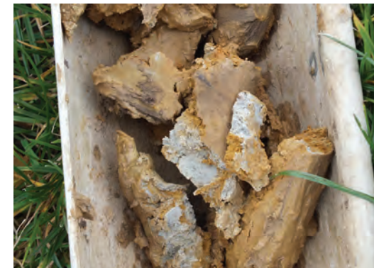
Traces d'hydromorphie oranges et grises dans le sol, repérées par carottage à la tarière
